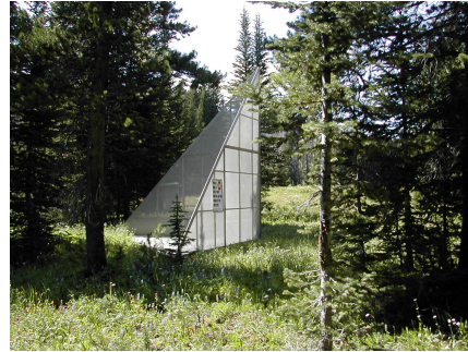
Fig. 7 Actual 16-foot corner reflector from YOGI dataset
